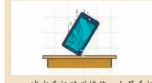
减少手机磕碰摔伤。大屏手机磕碰后容易导致内部变形,手机内电子元件刺破电池软膜,可能导致电池自燃或爆炸。
